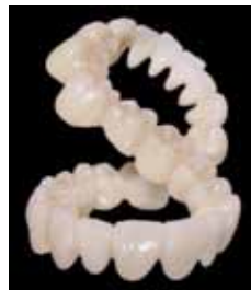
Тест на сколы: 6 сплавов с разными коэффициентами термального расширения, спаянные в 11-ти местах. 17 циклов обжига с финальным глазурированием.
