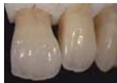
Тест на сколы: 6 сплавов с разными коэффициентами термального расширения, спаянные в 11-ти местах. 17 циклов обжига с финальным глазурированием.
